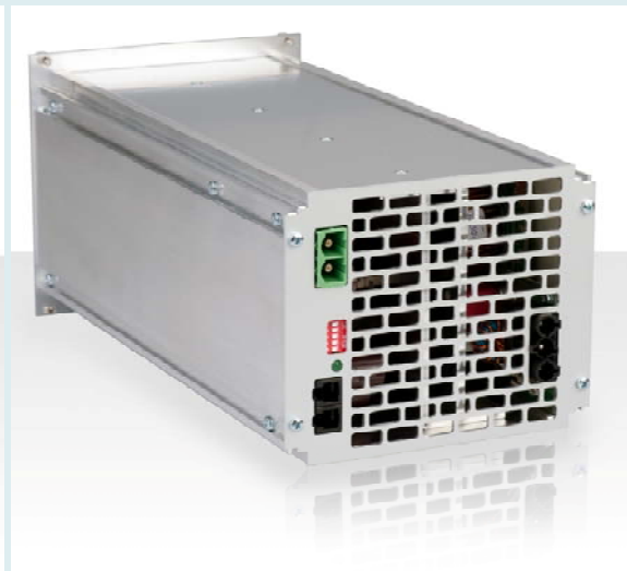
Foto: Netzteil mit AC-Eingang und Adress-Wahlschalter
